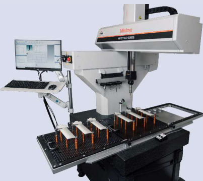
K543667: Dílenský SMS se základací stanicí eco-load duo pro MiSTAR
