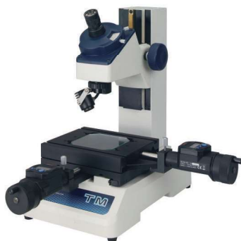
TM-505B vybaven volitelnými DIGIMATIC mikrometrickými hlavicemi
