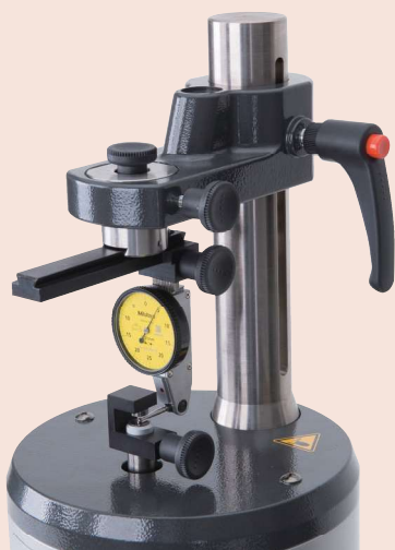
Kontrola číselníkových páčkových úchylkoměrů s volitelným příslušenstvím
