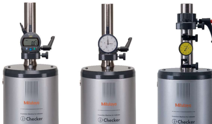
Kontrola číselníkových páčkových úchylkoměrů s volitelným příslušenstvím
