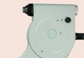
Nastavovací šroub pro číselníkový úchylkoměr \pm 5 \mu\text{m}
